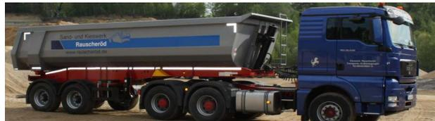
Lastwagen von 25 m Länge mit 25 t Zuladung und einem Transportvolumen von 16 m<sup>3</sup>.
